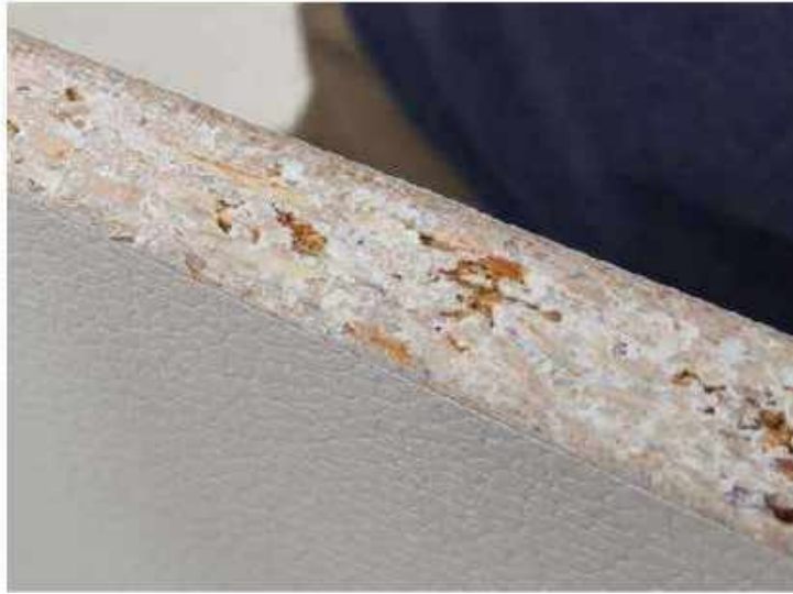
Figura 71. Esempio di strato funzionale delaminato
