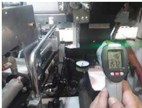
Figura 53. Termometro ad infrarossi su testina dell'adesivo
