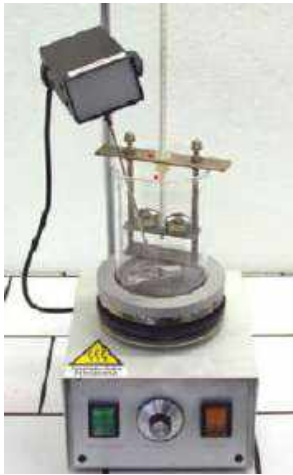
Figura 9. Dispositivo per la prova della temperatura di rammollimento (Ring & Ball)
