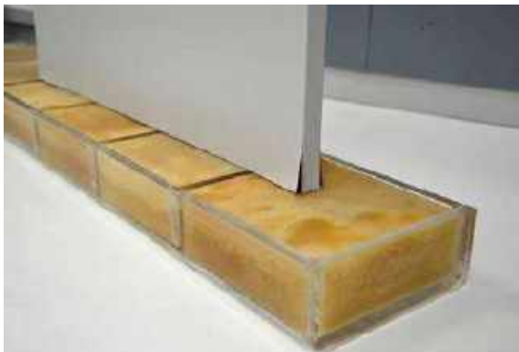
Figura 46. Prova di resistenza dei bordi all'acqua
