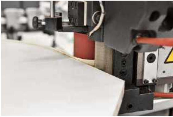
Figura 20. Bordatura con Centro di Lavoro (CNC)
