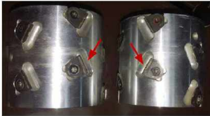
Figura 72. Esempio di utensili della rettifica usurati
