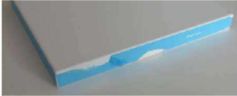
Figure 82. Esempio di bordo con pellicola rimossa dai copiatori frontali dell'arrotondatore
