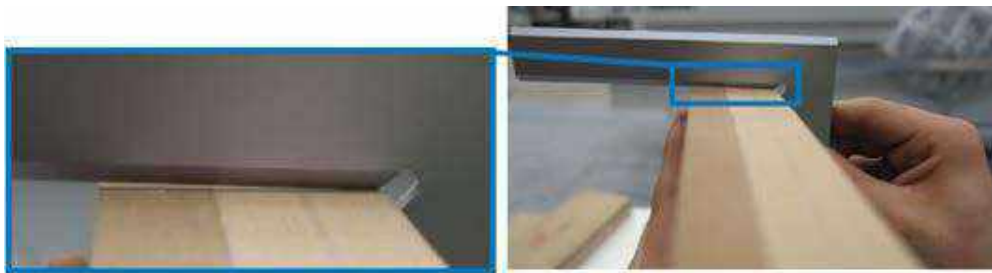
Figura 75. Esempio di pannello alto 45 mm rettificato con frese non in squadra
