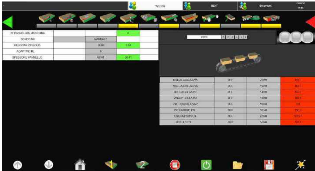
Figura 52. Parametri di fusione sul controllo della bordatrice
