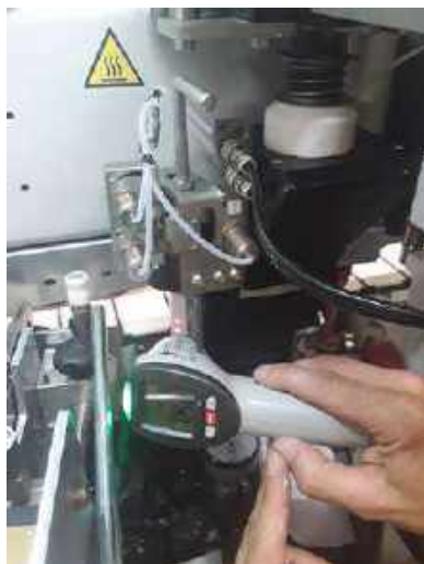
Figura 60. Termometro a infrarossi sul rullo applicatore
