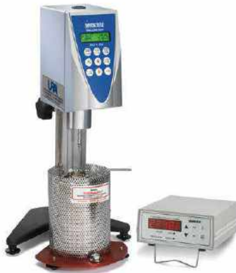
Figura 8. Viscosimetro rotazionale Brookfield con unità riscaldante
