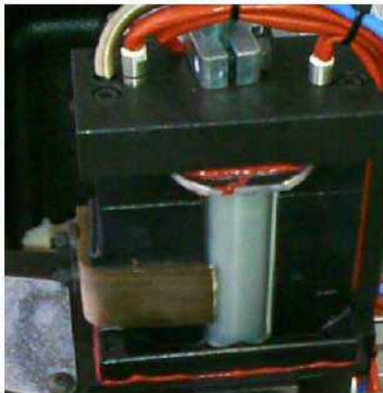
Figura 62. Rullo applicatore correttamente alimentato
