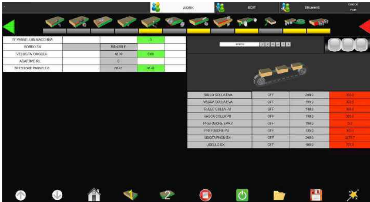
Figura 59. Pannello operativo di una bordatrice
