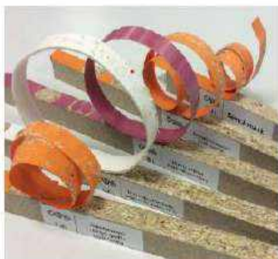
Figura 44. Bordi dopo la prova di peeling a 90°
