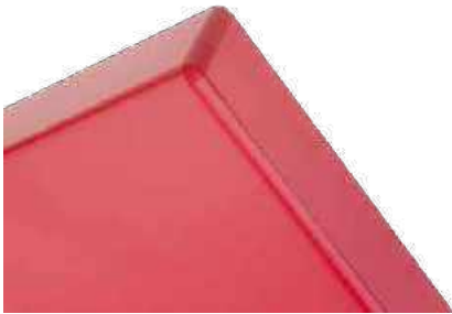
Figura 21. Bordo adeguatamente incollato
