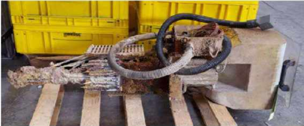
Figura 49. Esempio di prefusore non pulito
