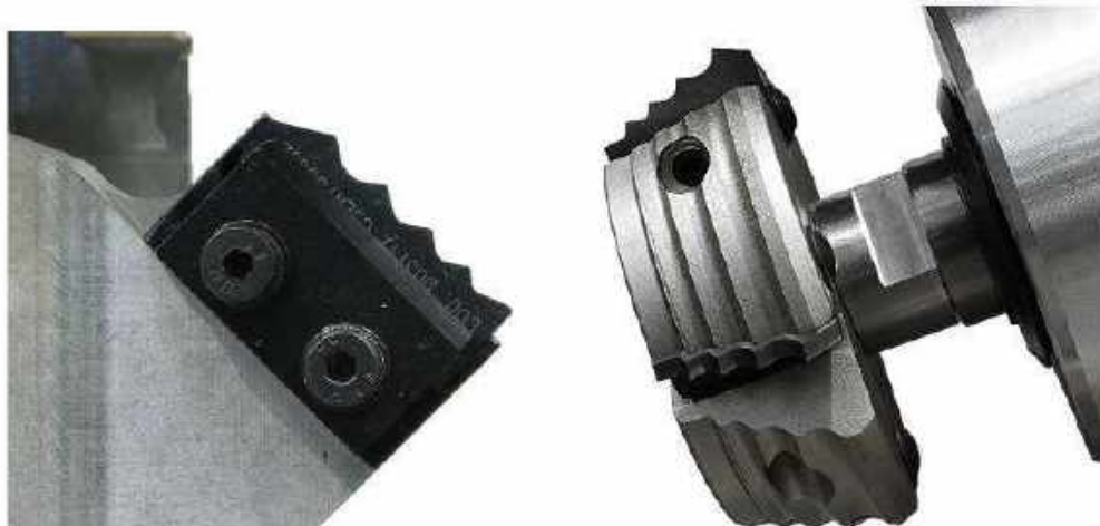
Figure 79. Esempio di utensili correttamente affilati
