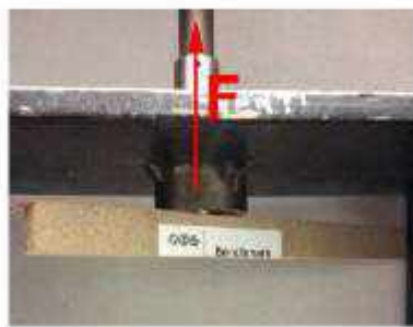
Figura 41. Prova di adesione – norma UNI 9240
