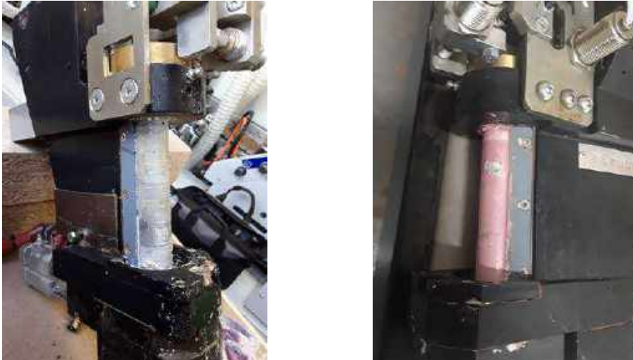
Figura 68. Esempi di testine con adesivo poliuretano reticolato
